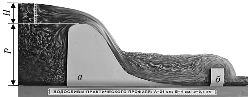
Рис. 12.2. Картина течения жидкости в устройстве № 6 через водосливы практического профиля с криволинейным ( а ) и полигональным ( б ) очертаниями
