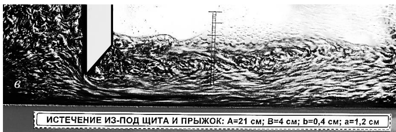
Рис. 13.2. Виды гидравлического прыжка в устройстве № 6:
