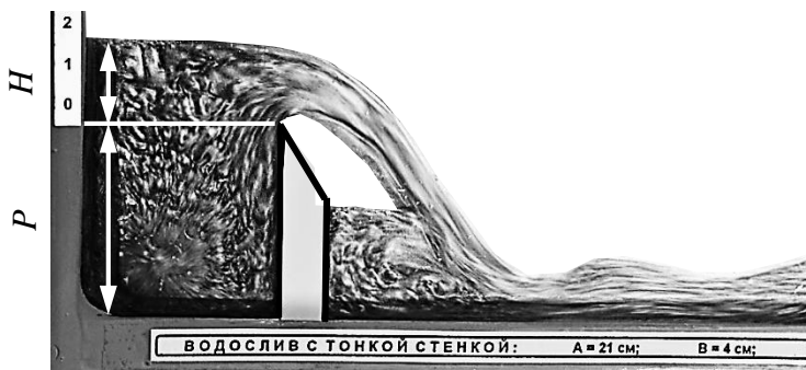
Рис. 10.2. Картина течения жидкости через водослив с тонкой стенкой в устройстве № 5
